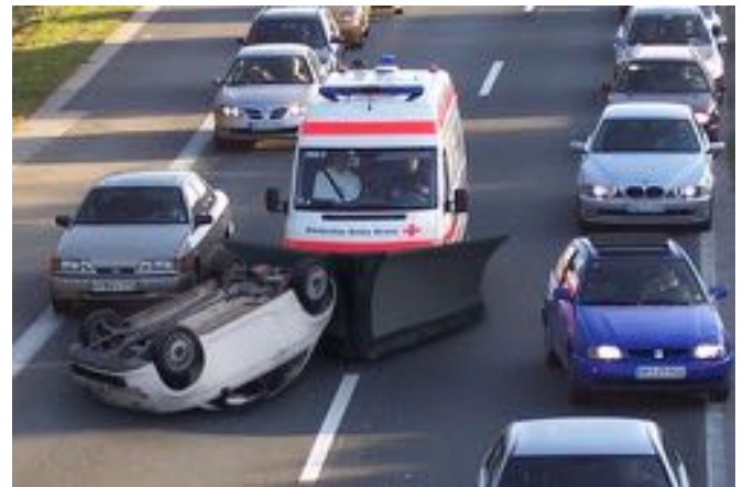
Der RTW mit Pflugerweiterung im Einsatz
