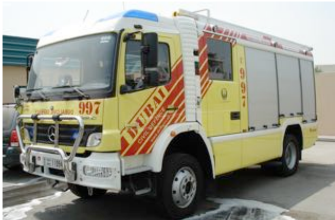
Tanklöschfahrzeug TLF 4000 Mercedes Benz, Rosenbauer NH 30 Pumpe, 4000 Liter Löschwasserbehälter, Hilfeleistungsgeräte ähnlich der deutschen HLF.
