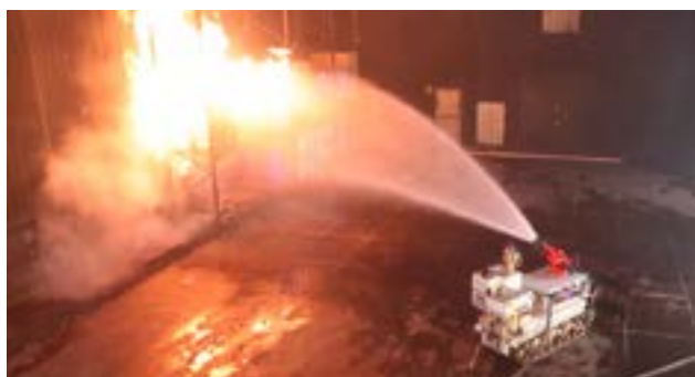
Der Löschroboter „D3“ bei der Innenbrandbekämpfung eines Hochregallagers (Bild: DRZ e.V.)
