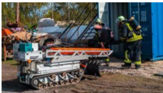
Der Bodenroboter „D3“ mit Schleifkorbtrage ausgerüstet zum Personentransport (Bild: DRZ e.V.)
