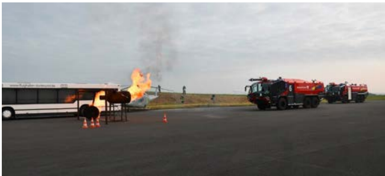
Anfahrt der Flugfeldlöschfahrzeuge der Flughafenfeuerwehr an einen simulierten Triebwerks- und Fahrwerksbrand
