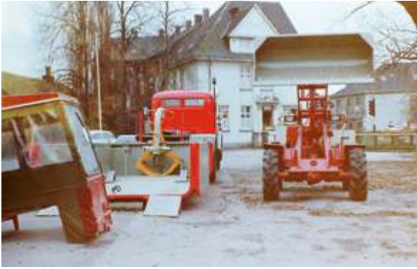
Hier erkennt man gut die Lagerung der Greifgabel am Kopf der Mulde (Foto FWDO)
