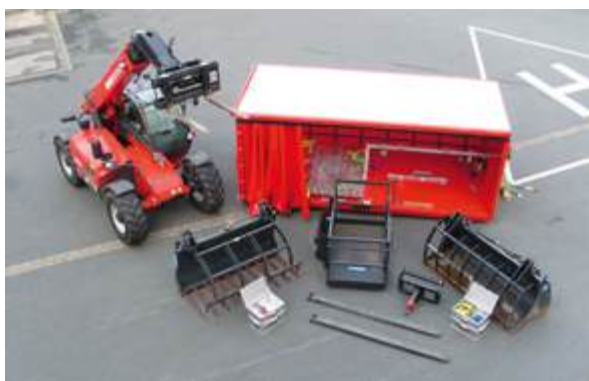
Der Tela mit den dazugehörigen Anbaugeräten, die in einem Wechselaufbau mit Schiebeplanen verlastet sind
