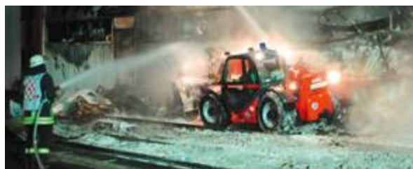
Bei einem Lagerhallenbrand schafft der Tela Öffnungen in die Hallenwand, um auch an dahinter liegende Brandherde zu gelangen (Foto FWDO)
