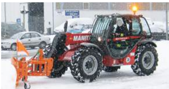
Zum Schneeräumen der Flächen von FW2 und ABZ kann der Tela mit einem Räumschild ausgestattet werden
