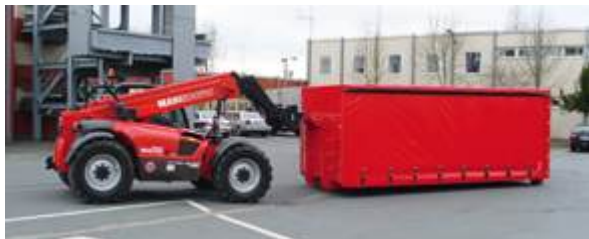
Mit einem am Ausleger befestigten Haken können Wechselaufbauten schnell umgesetzt werden
