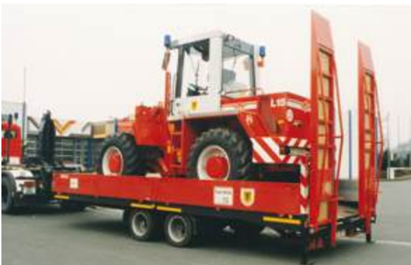
Zeitweise wurde versucht den L15 auf einem Anhänger zur Einsatzstelle zu bringen, dies wurde aber wegen der zu Großen Höhe des Gespannes verworfen
