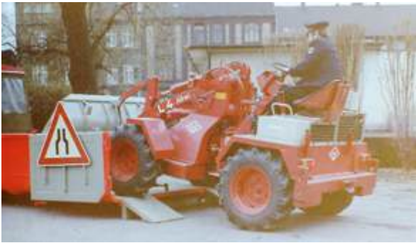
Das Befahren der Mulde mit dem Rala wurde durch kleinen Auffahrampen erleichtert (Foto FWDO)
