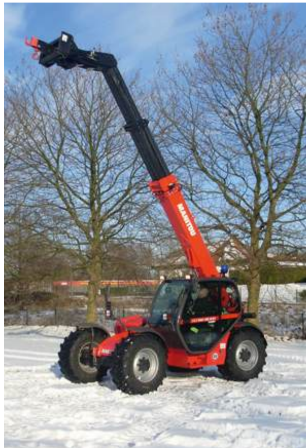
Der Ausleger des Manitou ist zweifach teleskopierbar
