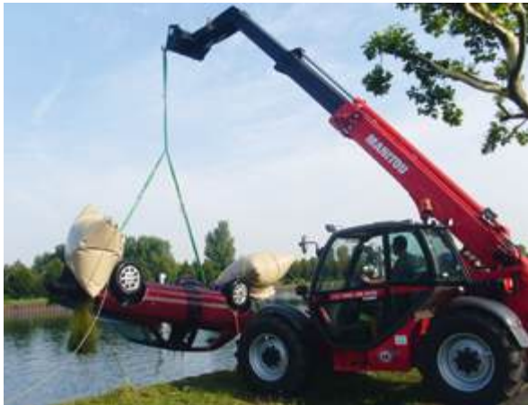
Mittels Manitou wird ein Auto aus dem Kanal geborgen, an dem Taucher Hebekissen angebracht hatten
