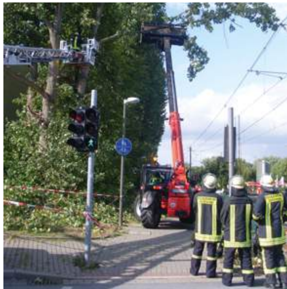
Der Tela im Einsatz mit der Schaufel und angebrachtem Greifer bei der Sicherung eines größeren Astes neben der Fahrleitung der Stadtbahn
