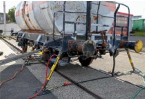
Abb. 14 Anheben eines Bahnwaggon bei paralleler Sicherung durch Rettungsstützen. Seitliches Schwenken wird durch den Einsatz zweier Mehrzweckzüge verhindert. Foto Siekaup
