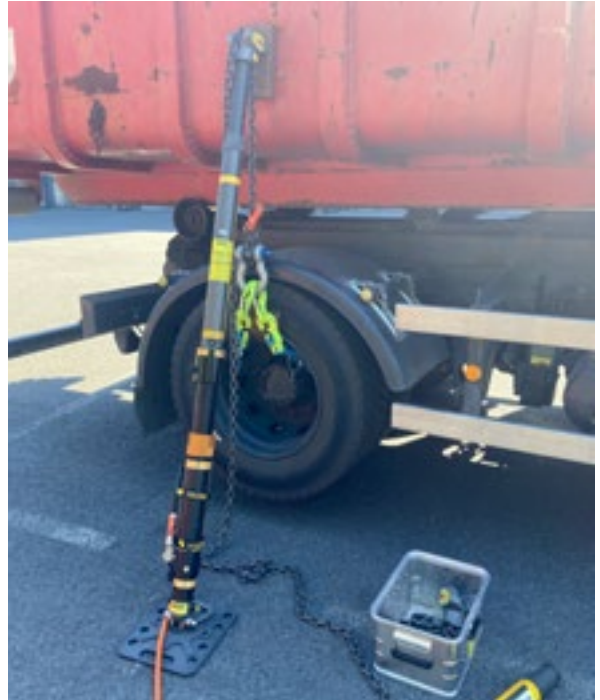
Abb. 12 Schnelles einseitiges Anheben eines Rades mit einer Kette und HFS. Foto Siekaup
