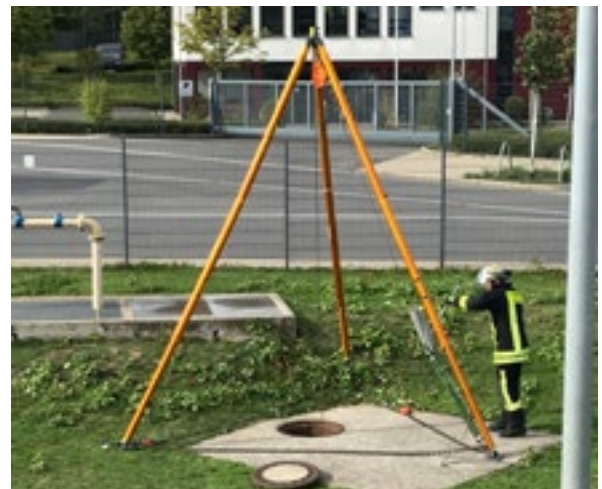
Abb. 2 Einsatz des Dreibein über einem Schacht zur Materialversorgung oder Menschenrettung (Nur mit SE-H). Foto Siekaup
