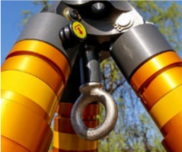
Abb. 3 Verbindungsteil mit Lastöse, Traglast 2,3t. Foto Hellmann
