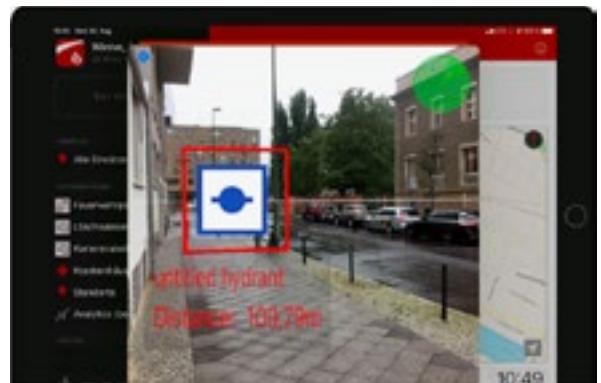
Hydrantensuche mit AR
