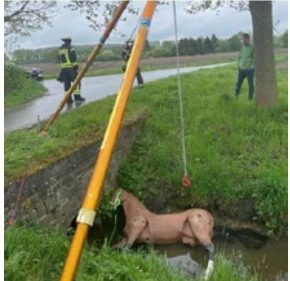
Abb. 6 Großtierrettung mit dem Zweibein. So kann dem liegenden Großtier langsam hoch geholfen werden. Foto Feuerwehr Ibbenbüren/Heavy Rescue Germany
