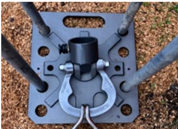
Abb. 1 Bodenplatte 300x300 mit eingeschlagenen Erdnägeln für eine Zugkraft bis zu 2t. Foto Pufahl
