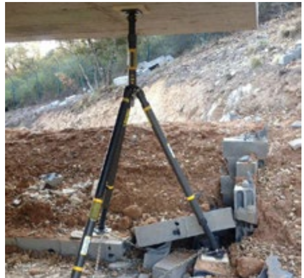
Abb. 4 Dreibein mit aufgesteckter Stütze in unebenem Terrain. Foto Heavy Rescue Germany
