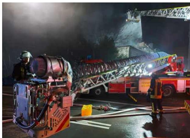
Flexi Foam System installiert an einer Drehleiter
