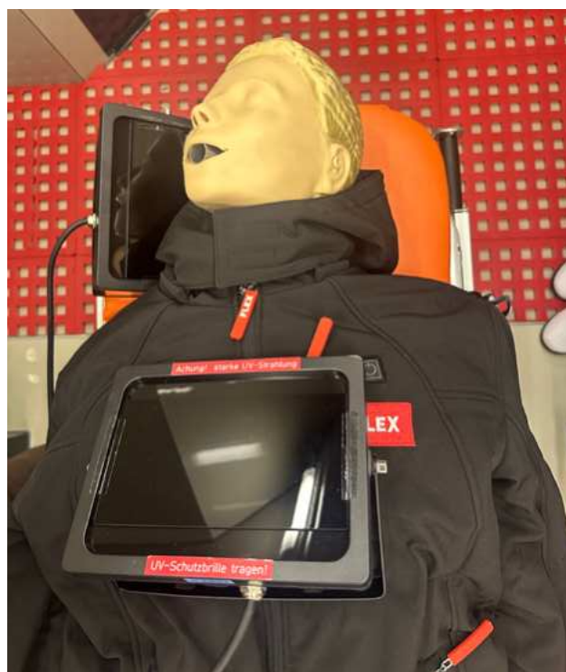
Versuchsaufbau zum Nachweis von Oberflächenkontaminationen durch Atemaerosole
