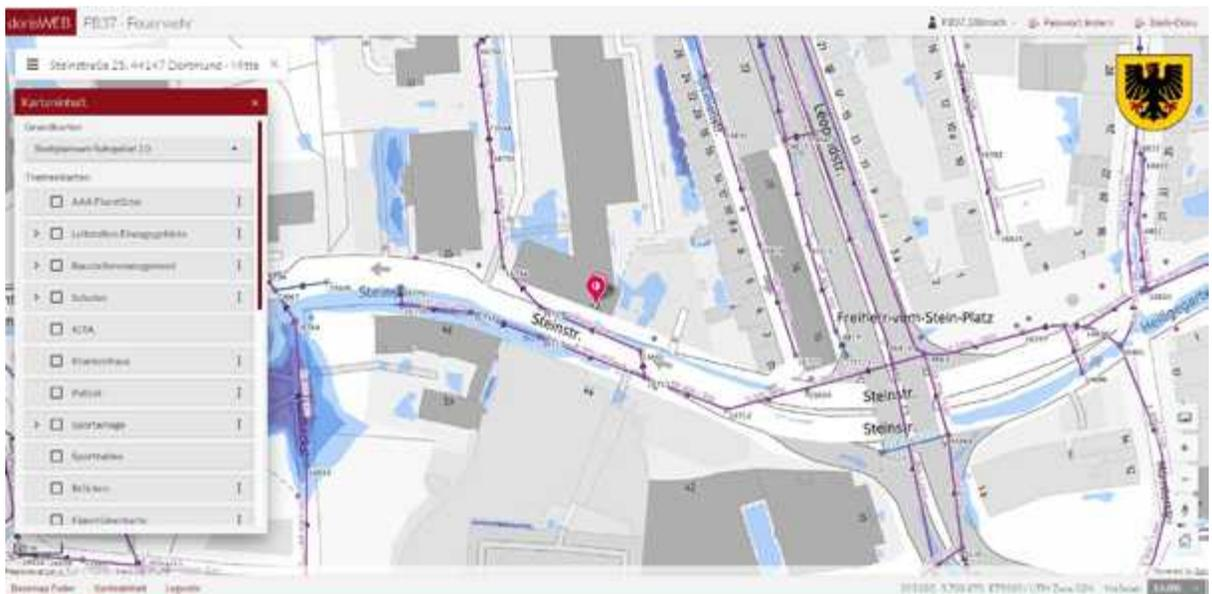
Flurkarte mit dem Layer der Kanalisation inkl. Fließrichtung, sowie der Überschwemmungsgebiete und den Hydranten
