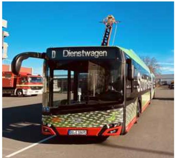
Abb. 9: E-Bus mit ausgefahrenem Pantographen
