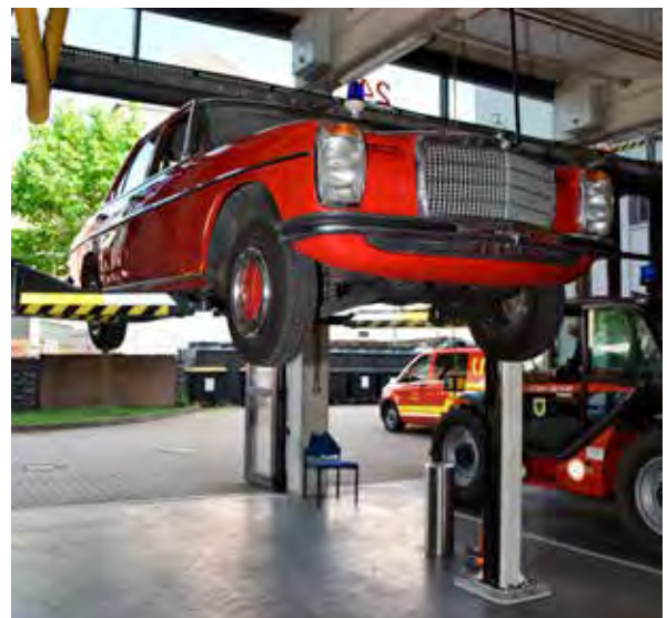
Um die Betriebsstoffe abzulassen wurde der alte Benz auf die Hebebühne gefahren
