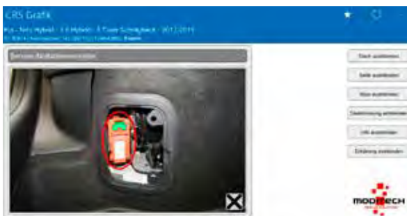
Abb. 13: Trennstelle für das HV-System
