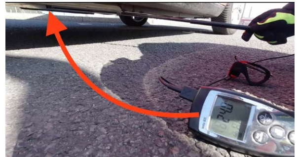
Abb. 8: Einsatz der teleskopierbaren Temperaturmesssonde (Foto: Jonas Planken)
