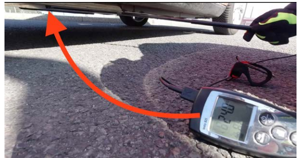
Abb. 8: Einsatz der teleskopierbaren Temperaturmesssonde (Foto: Jonas Planken)
