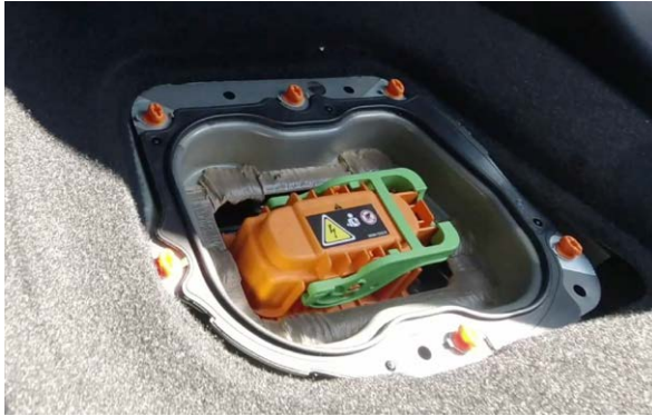
Abb. 6: Hochvolttrennstelle eines Renault Zoé (Foto: Jonas Planken)
