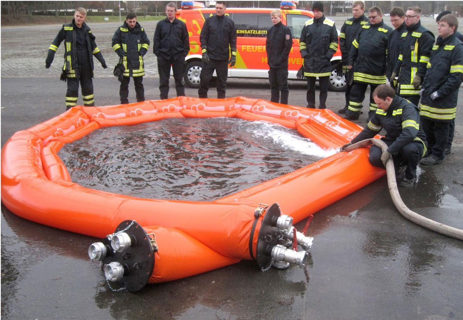
Abb. 4: Stationsausbildung: Doppelkammerschlauch zur Löschwasserrückhaltung (Foto: Feuerwehr Dortmund)
