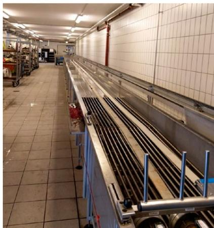
Schlauchprüfung – Sicht auf den Schlauchtisch
