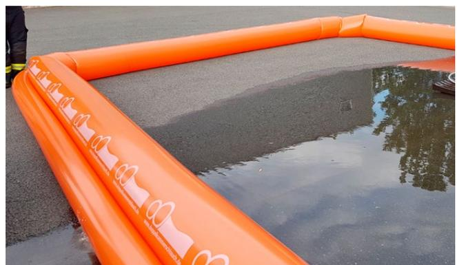
Abb. 3: Der Doppelkammerschlauch als mobiles Auffangbecken
