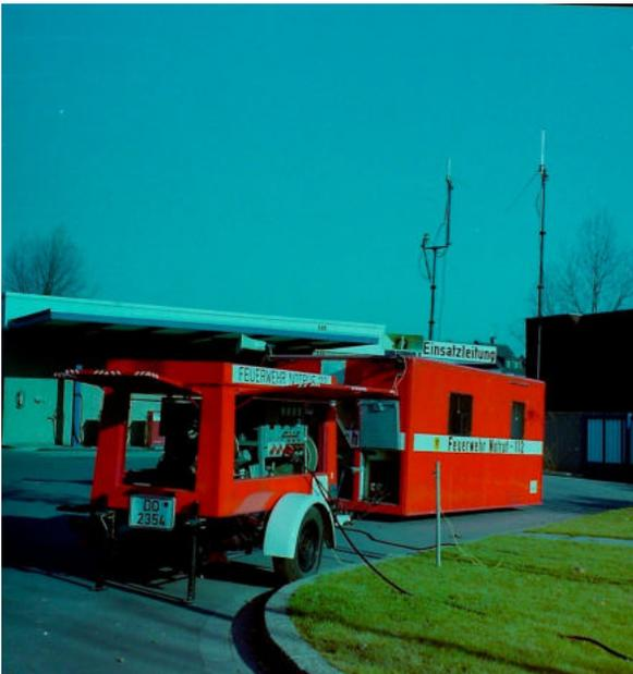
Ohne Strom kein Funkbetrieb, Stromaggregat und WA in Betrieb
