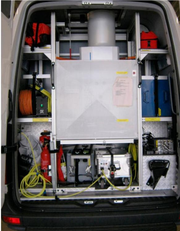
Mittig verdeckt durch eine Blende ist das SIGIS 2 auf einer Hebebühne eingebaut
