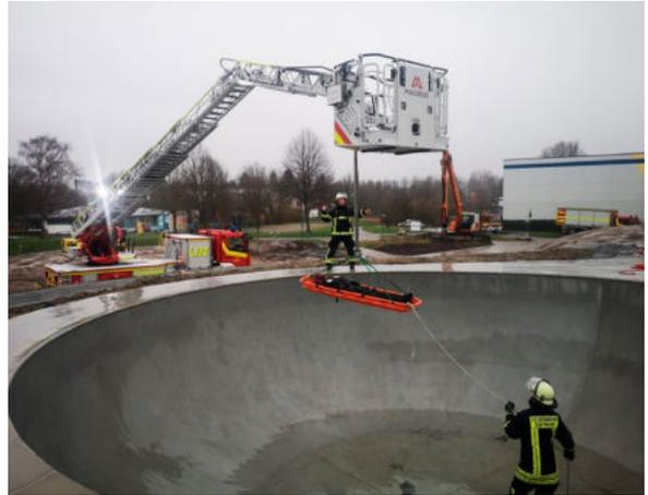
*Der Schleifkorb wird mit der DLK aus der Bowl gehoben*
