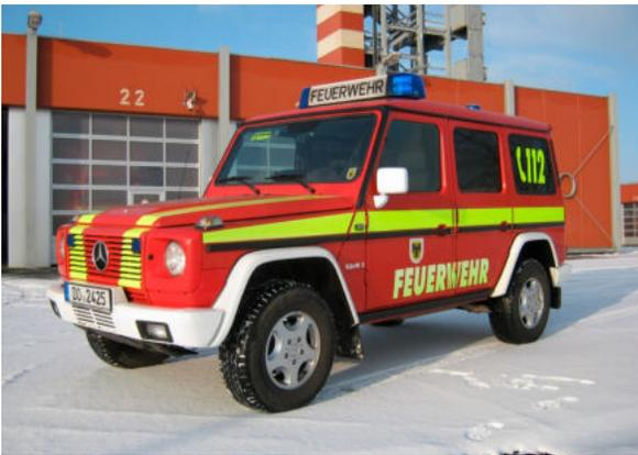
KdoW3 auf MB-G, wird auch als First Responder-Fahrzeug bei der FF eingesetzt.
